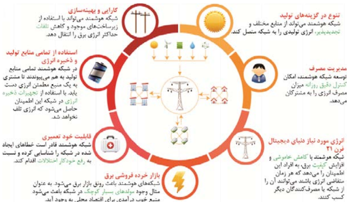
شکل (۸): ساختار کلی شبکه‌های الکتریکی هوشمند
